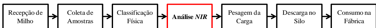
Figura 4: Fluxograma do recebimento e estocagem de milho na fábrica de rações Fonte: Elaborada pelos autores.
